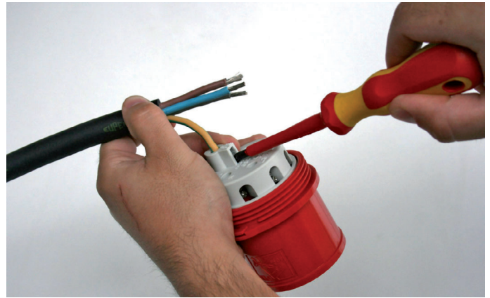
2. Die einzelnen Leiter entsprechend der Abdeckplattenkennzeichnung mittels Schraubendreher PZ1 anschließen.
