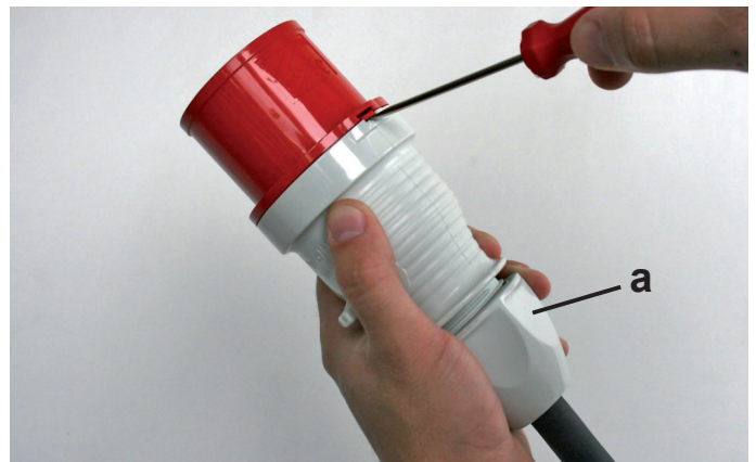
6. Zur Demontage zuerst die Kabelverschraubung (a) aufdrehen. Danach Schlitzschraubendreher, Klingenbreite 3,0 mm, tief in den Öffnungsschlitz des Griffhinterteiles eindrücken. Durch Rechtsdrehen des Schraubendrehers wird die Verrastung aufgehoben.
