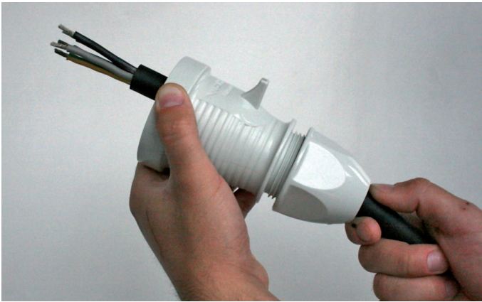
1. Kabel ca. 50 mm abmanteln und ca. 10 mm abisolieren, dann durch das Griffhinterteil einführen.
