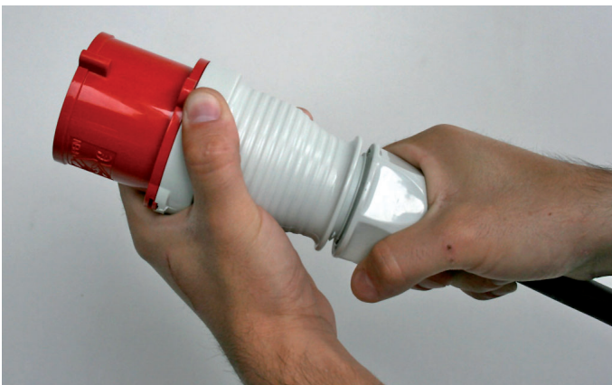
5. Zum Schluss die Kabelverschraubung fest andrehen (Drehmoment min. 4 Nm) – fertig!
