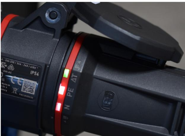
► LED-Anzeige Neutral- und Schutzleiter Monitoring, Temperatur Monitoring
