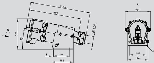
**CEE Hochstrom Wandsteckdose mit Schraubanschluss**
