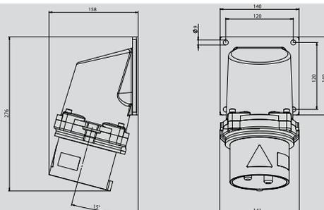
**CEE Hochstrom Anbaustecker abgewinkelt mit Schraubanschluss**
