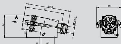
**CEE Hochstrom Wandstecker mit Schraubanschluss**
