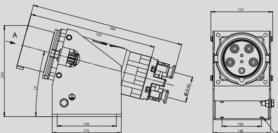
**CEE Hochstrom Wandstecker mit Schraubanschluss**
