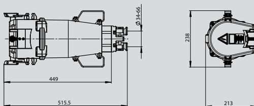
**CEE Hochstrom Kupplung mit Schraubanschluss**
