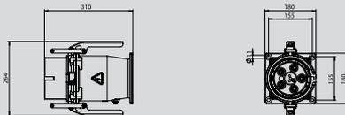
**CEE Hochstrom Anbaustecker gerade mit Schraubanschluss**
