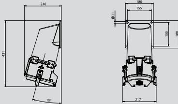
**CEE Hochstrom Anbaudose abgewinkelt mit Schraubanschluss**
