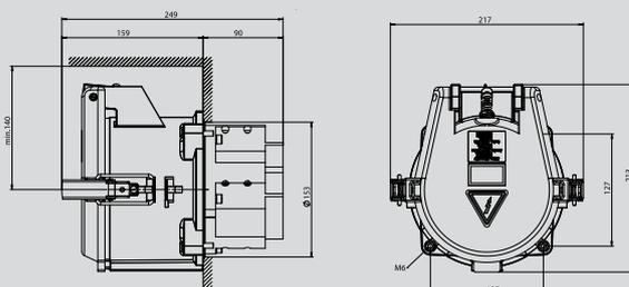
**CEE Hochstrom Anbaudose gerade mit Schraubanschluss**
