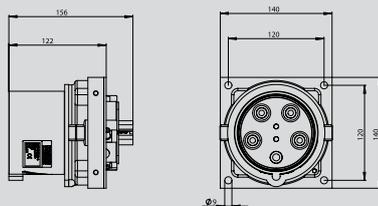
**CEE Hochstrom Anbaustecker gerade mit Schraubanschluss**
