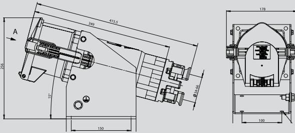
**CEE Hochstrom Wandsteckdose mit Schraubanschluss**
