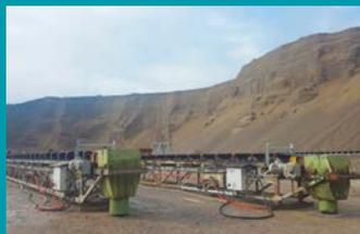
**Kieswerke** | Steckvorrichtungen werden für die Stromversorgung von Förderbändern eingesetzt. IP 67 und IK 10 bieten Schutz vor äußeren Belastungen.
