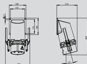
**CEE Hochstrom Anbaustecker abgewinkelt mit Schraubanschluss**
