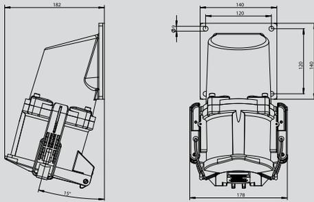
**CEE Hochstrom Anbaudose abgewinkelt mit Schraubanschluss**
